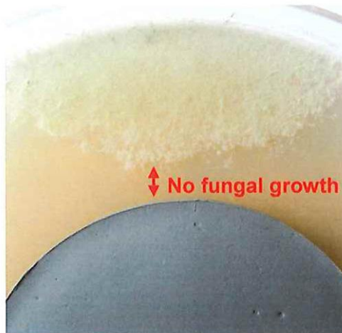
2.attēls: Materiāls Zwaluw Acryl Ducting Seal (pelēkā krāsā) : Pelējuma ietekmes testēšanā tieši ap materiālu netika konstatēts pelējums.
