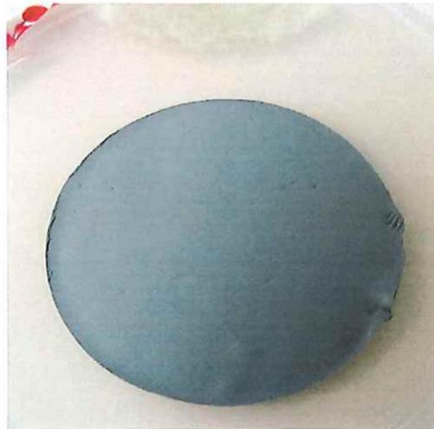
1.attēls: Materiāls Zwaluw Acryl Ducting Seal (pelēkā krāsā) : pelējuma attīstība nav redzama ar neapbruņotu aci
