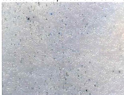
3.attēls: Materiāls Zwaluw Acryl Ducting Seal (pelēkā krāsā) : (50x palielinājumā): pelējuma attīstība mikroskopā nav redzama
